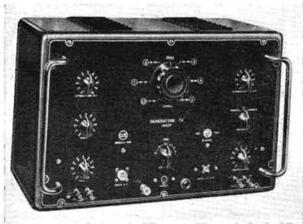
Fig. 7.1 - Aspecto esterno di generatore di segnali TV (sweep). La deviazione di frequenza è ottenuta con lamina vibrante fissata ad equipaggio di altoparlante. L'ampiezza della deviazione può giungere a 12 megacicli. Il generatore consente di ottenere i segnali per l'allineamento delle medie frequenze da 0,3 a 50 megacicli e quelli per i circuiti accordati dei cinque canali TV. (CGE mod. 304).
